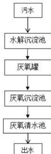
图2-8 UASB工艺流程
