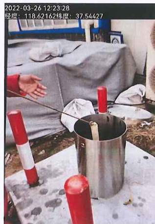
图 4 3#地下水采样照片
